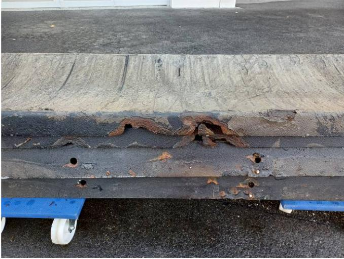
Hebewerk durchgerostete Leitbleche.
