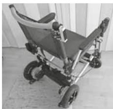
Mit dieser einfachen, 60 Gramm leichten Halterung lässt sich dieser elektrische Rollstuhl von einer Begleitperson zuverlässig steuern. Die Halterung ist innert weniger Sekunden montiert oder demon- tiert.
